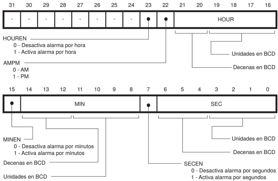
Figura A.11: Formato del registro RTC Time Alarm Register
