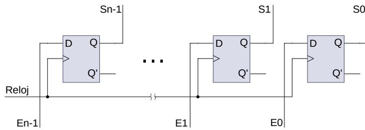
Figura 3.1: Registro de  $n$  bits. Cada uno de los biestables tipo D almacena el valor de un bit, que proporciona en su salida  $Q_i$ . Las entradas  $E_i$  junto con la señal de reloj, sirven para actualizar el contenido del registro
