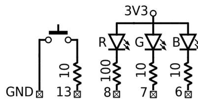
Figura 9.8: Esquema de la tarjeta de E/S
