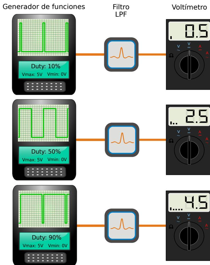
Figura 10.3: Método PWM para la conversión Digital/Analógica
