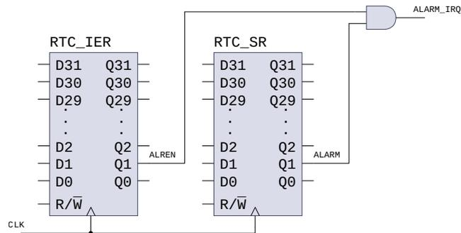
Figura 10.2: Elementos de un dispositivo que intervienen en una petición de interrupción. La petición de interrupción `ALARM_IRQ` de un reloj en tiempo real (RTC) solo se activará cuando se active el bit `ALARM` del registro de estado `RTC_SR` al saltar la alarma y esté habilitada la petición de interrupción por alarma (bit `ALREN` del registro de control `RTC_IER` a 1)
