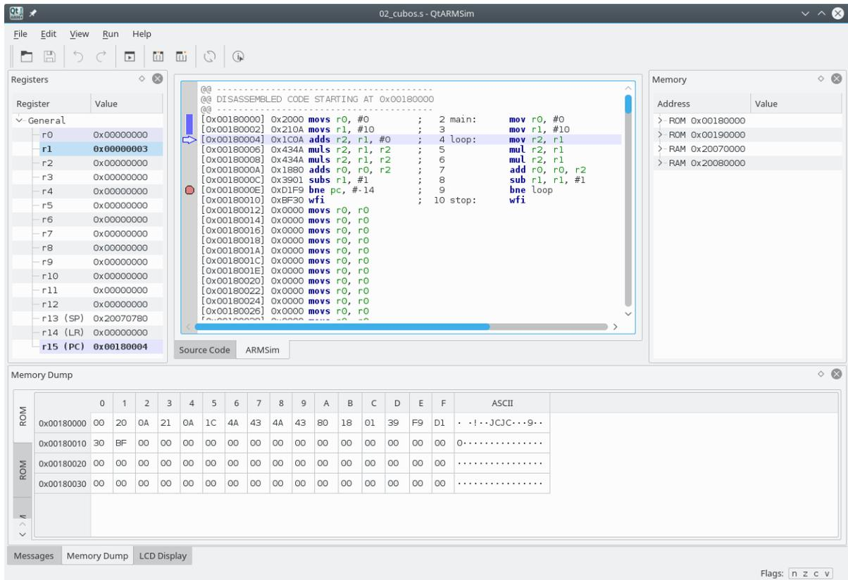
Figura 2.9: Punto de ruptura en la dirección 0x0018000E
