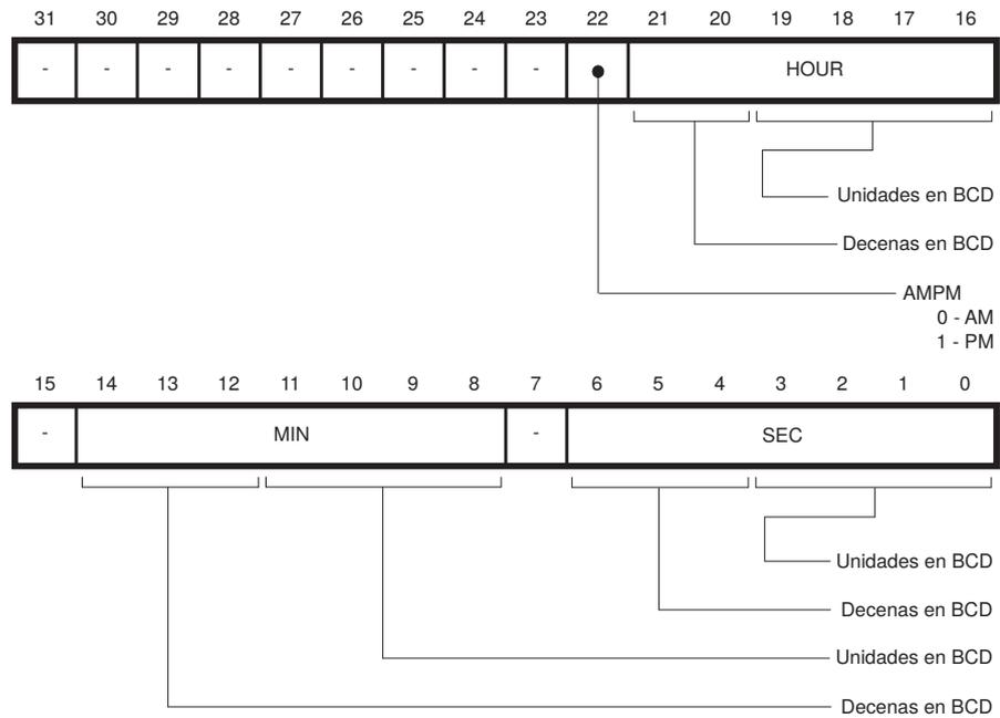
Figura A.5: Formato del registro RTC Time Register
