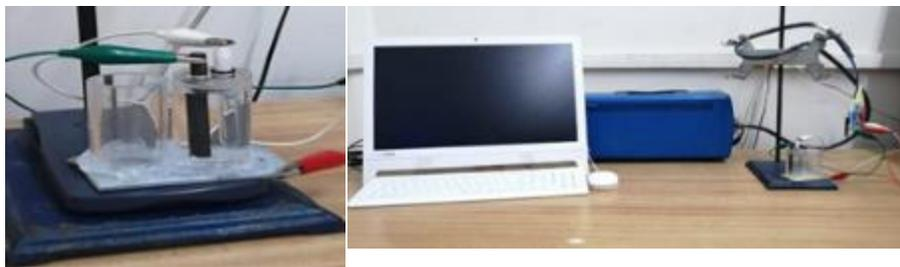
**Figura 3.** a) Celda electroquímica y electrodos, b) Sistema integrado para calcular la velocidad de corrosión de los materiales metálicos (PC y potenciostato).
