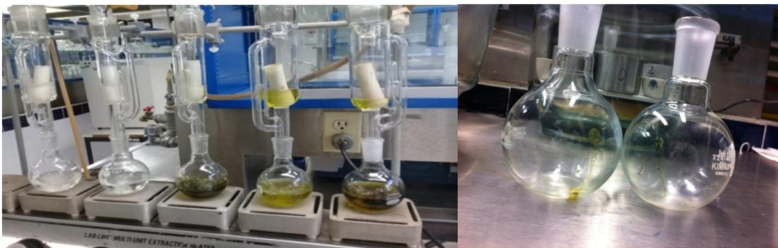
Figura 22. Extracción de grasa con sistema Soxhlet
